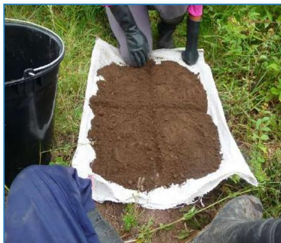
Figura 3. Cuarteo de una muestra compuesta en campo.
