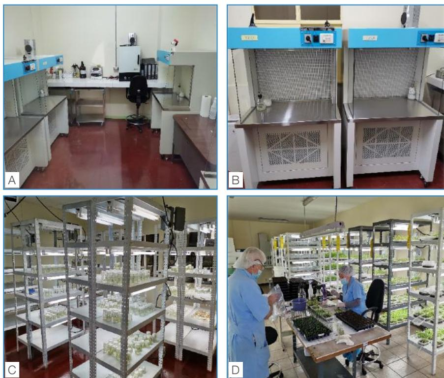
Figura 79. Equipo e instalaciones del LCT. (A) Área de transferencia (micropropagación vegetativa *in vitro*). (B) Cámaras de flujo laminar, para cultivo de tejidos. (C) Área de crecimiento vegetal. (D) Área de propagación y crecimiento vegetal SAH.
