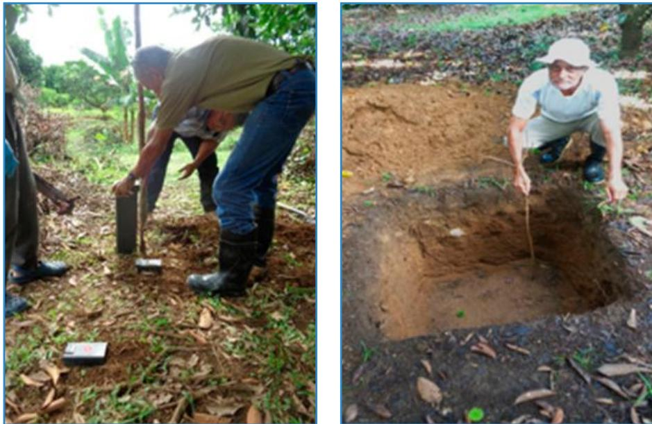
Figura 23. Instalación de anillos de medición (izq.) y calicata de 60 x 60 cm (der.) San Martín, Paso Canoas. 2020.
