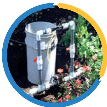
Figura 23. Venturi instalado en una finca.
