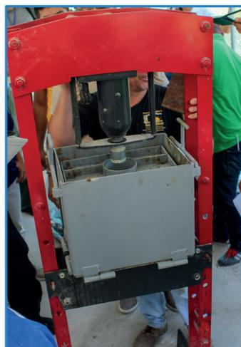
Figura 2 y 3. Moldes para la elaboración de bloque.
