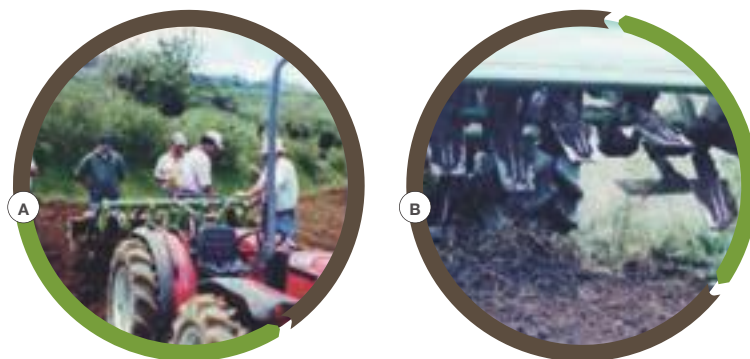
Figura 10. A. Tractor liviano. B. Arado de palines o palín mecánico que no vuelve el suelo. INA, Cartago. 2002.
